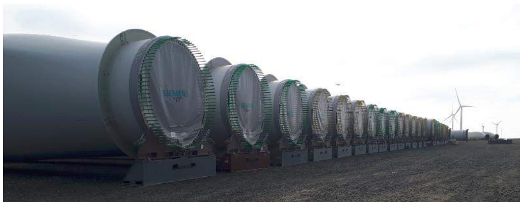
Figure 56 : exemples de stockage de pales sur un site SGRE / ©Siemens Gamesa
